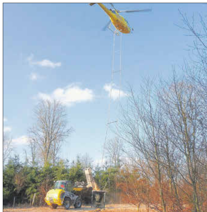
Beladung des Kalkstreuers durch Radlader
